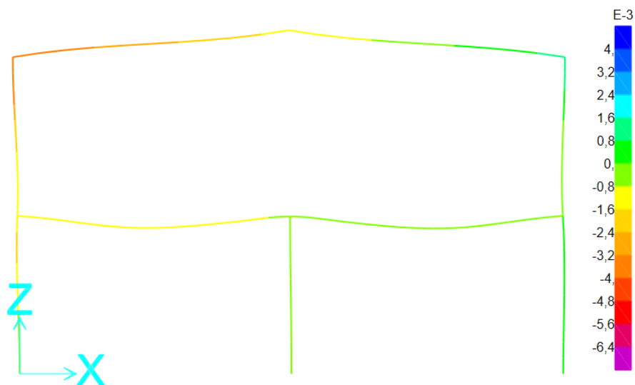
Figura 52: Diagrama da estrutura deformada do pórtico D – SAP2000
