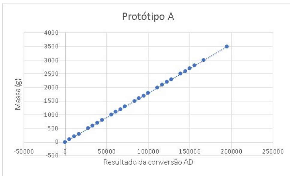
Figura 24 – Resultado da célula de carga de 5 kg operando junto ao módulo ADS1230.
