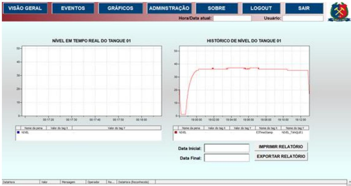
Figura 3.12 - Tela do Sistema de Supervisão e Aquisição de Dados onde se registra os níveis em tempo real, exibe histórico e exporta relatórios.
