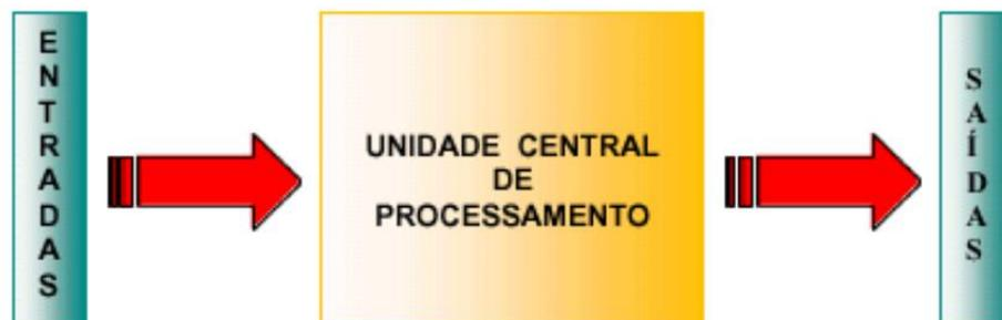
Figura 2.8 - Esquema básico do CLP.
