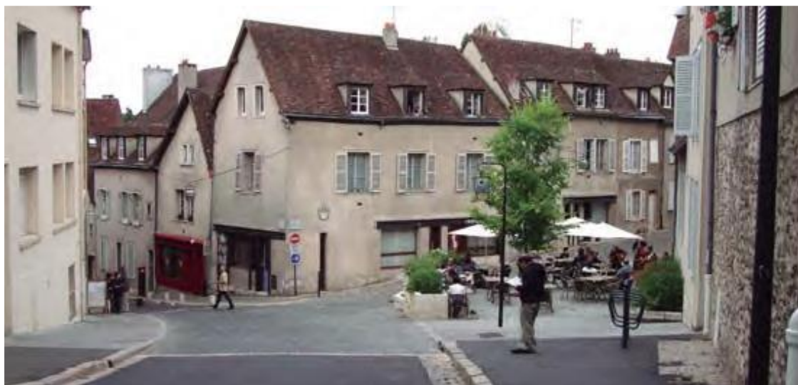
Figura 5: Rebaixamento de calçadas permitindo livre circulação e acessibilidade, Chartres/França, 2011. Fonte: RIBEIRO, S. (2014)
