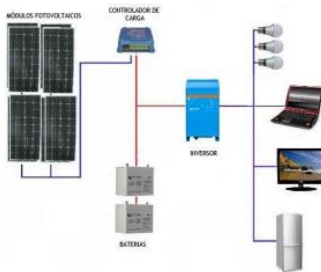
Figura 19 – Sistema isolado com baterias de armazenamento.
