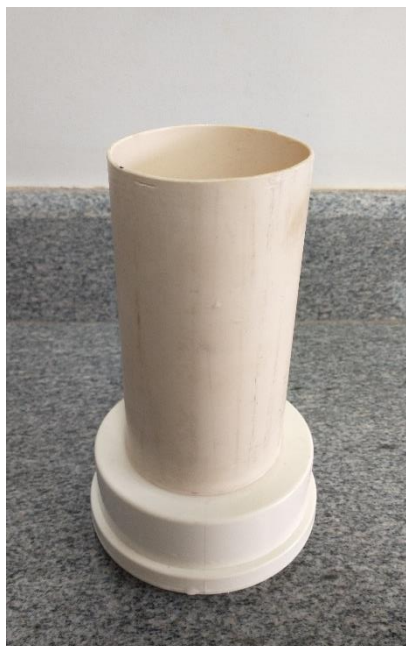
Figura 12 - Reator utilizado nos testes de floculação seletiva
