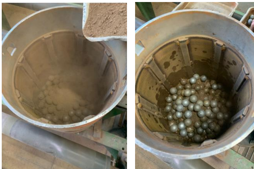
Figura 6 - Construção de uma sequência de camadas de cargas de bolas, minério e água, no interior do moinho
