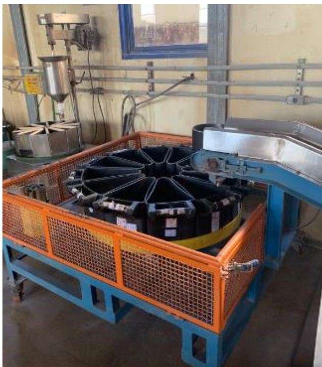
Figura 4 - Quarteador do tipo carrossel
