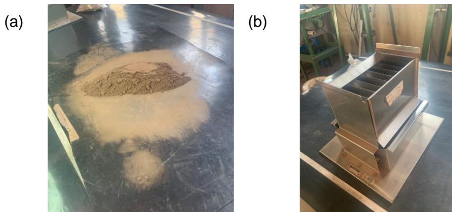
Figura 5 - Lona de homogeneização e quarteador do tipo Jones
