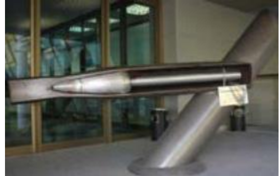
b) Visão esquemática interna do mandril de laminação do tubo
