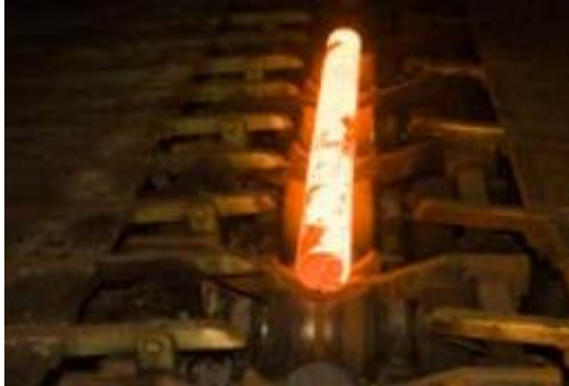
a) Bloco circular maciço sob alta temperatura sendo conduzido para o laminador
