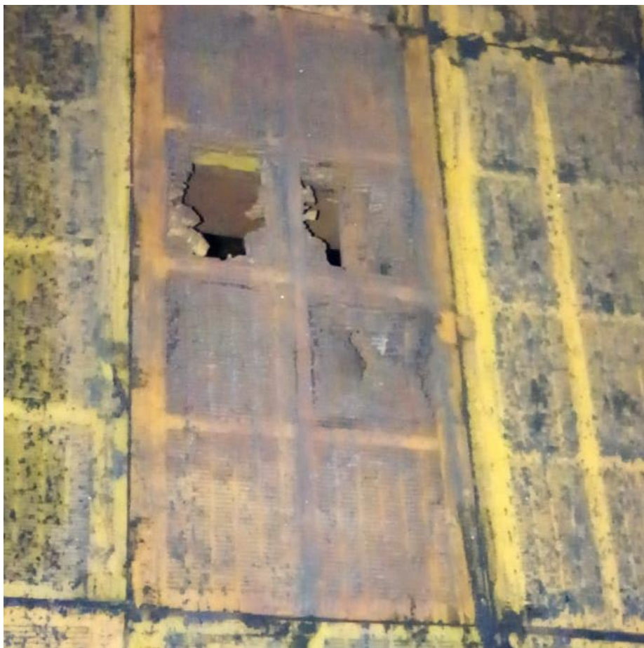
Figura 18 – Rompimento da tela da peneira desaguadora
