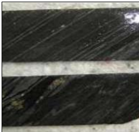
Figura 20. Filito Grafitoso em testemunhos de sondagem (Trópia, 2013).
