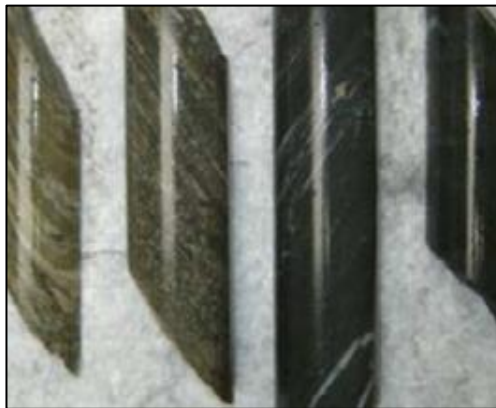
Figura 19. Metabasaltos (MBA) com diferentes níveis de alteração hidrotermal (Trópia, 2013).
