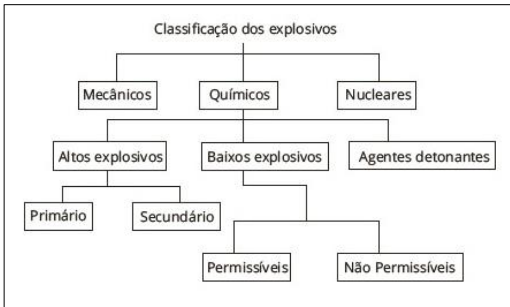
Figura 3. Classificação dos explosivos - Adaptado de Silva (2001).
