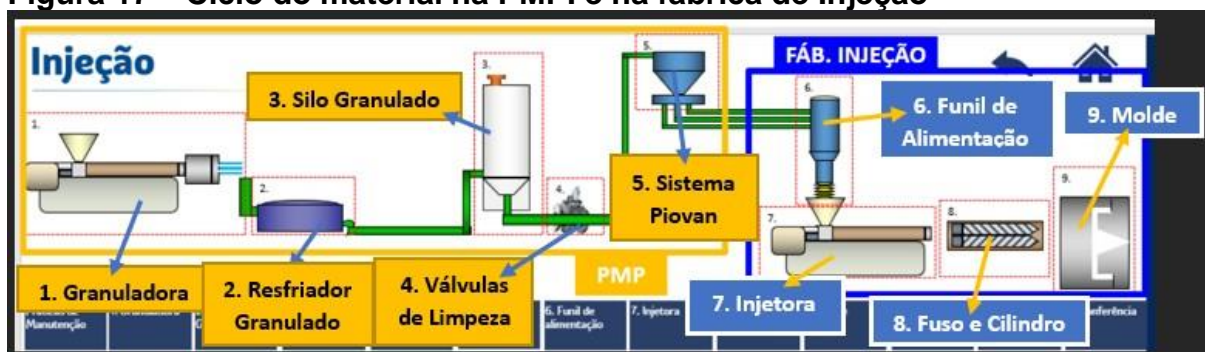
Figura 17 – Ciclo do material na PMP e na fábrica de Injeção
