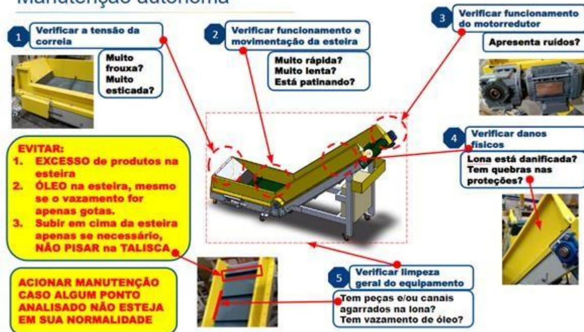
Figura 37 - Manutenção autônoma nas esteiras Manutenção autônoma
