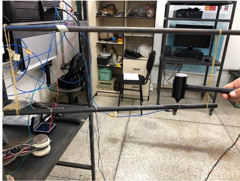
Figura 25 - Teste de impacto inicial para o martelo em desenvolvimento Fonte: Pesquisa direta (2022).
