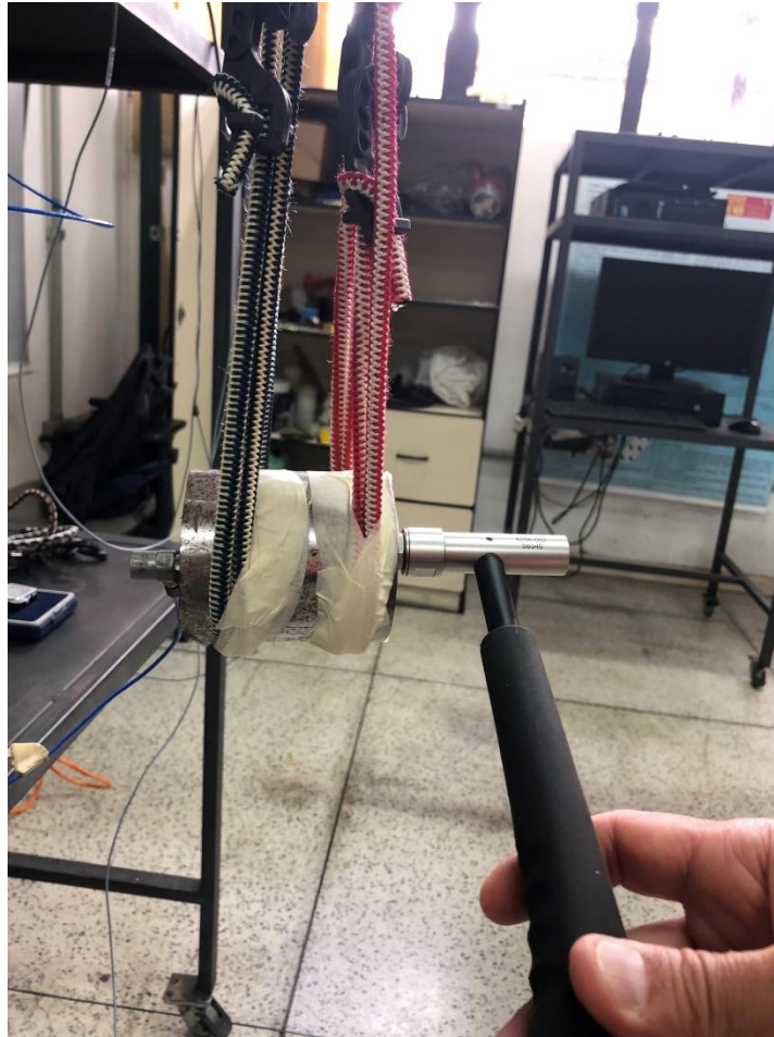
Figura 20 - Montagem da calibração utilizando o martelo comercial Fonte: Pesquisa direta (2022).
