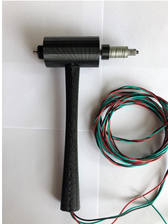
Figura 29 - Montagem completa do martelo Fonte: Pesquisa direta (2023).
