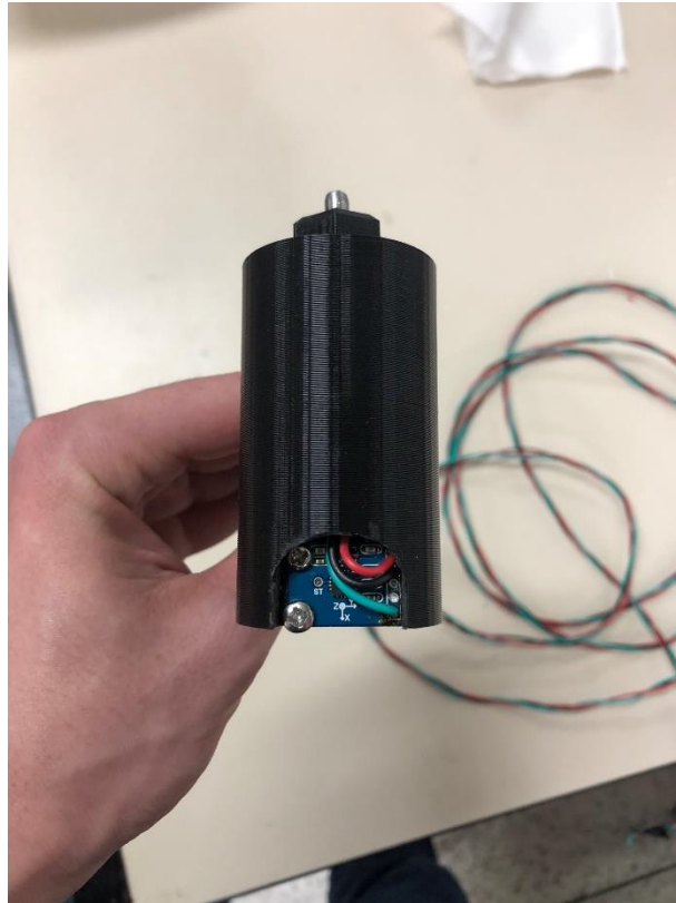
Figura 18 - Martelo montado visão do sensor. Fonte: Pesquisa direta (2022).
