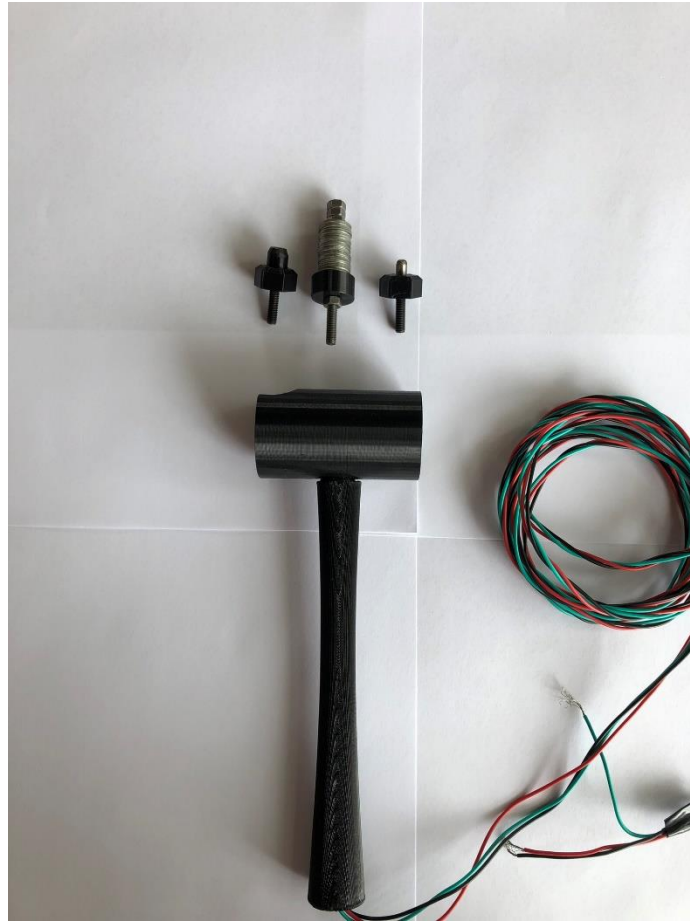
Figura 28 - Martelo de impacto, ponteiras e peso extra Fonte: Pesquisa direta (2023).
