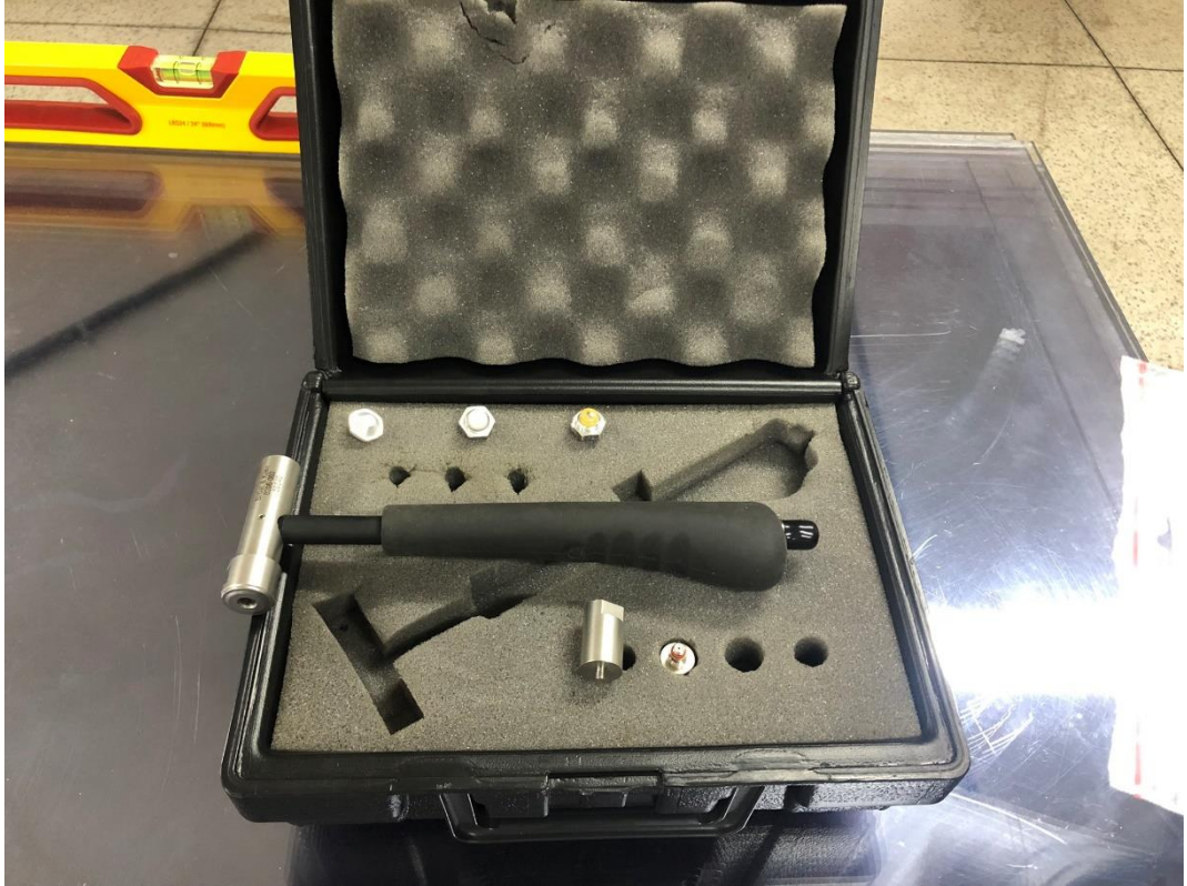
Figura 9 - Martelo de impacto B&K Tipo 8206
