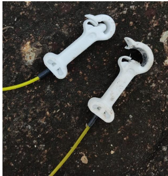
Figura 12 - Espoleta não detonada e detonada
