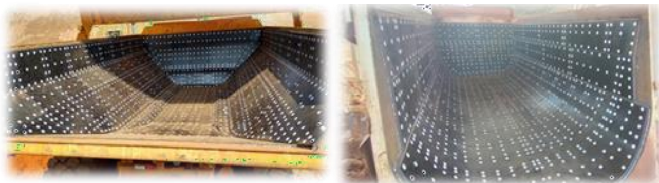
FIGURA 332: Caçambas de caminhões forradas
