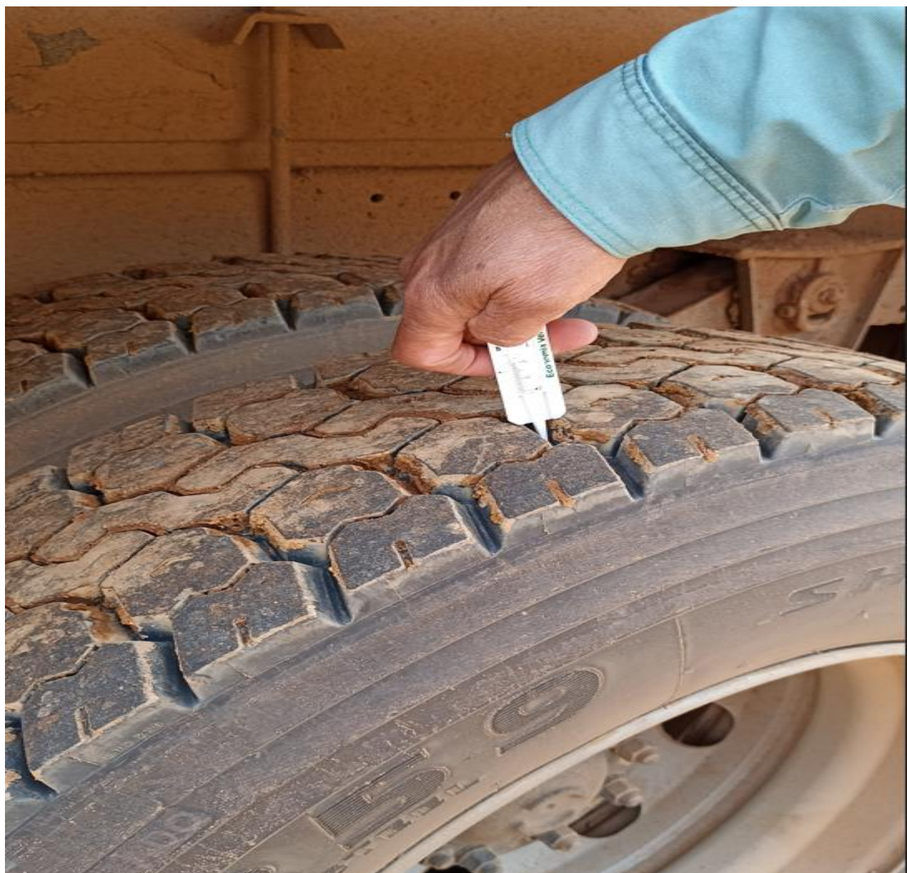
Figura 10 - Estado de conservação dos pneus.
