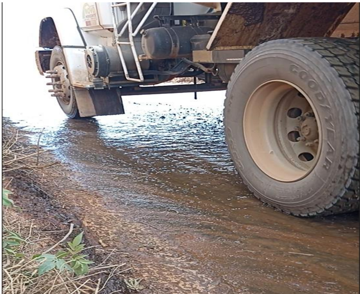
Figura 8 - Caminhão realizando a subida com o piso molhado.
