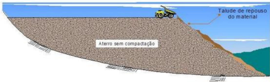
Figura 3.3 - Construção de pilha de estéril por meio do método descendente. Adaptada de Freitas, 2004.
