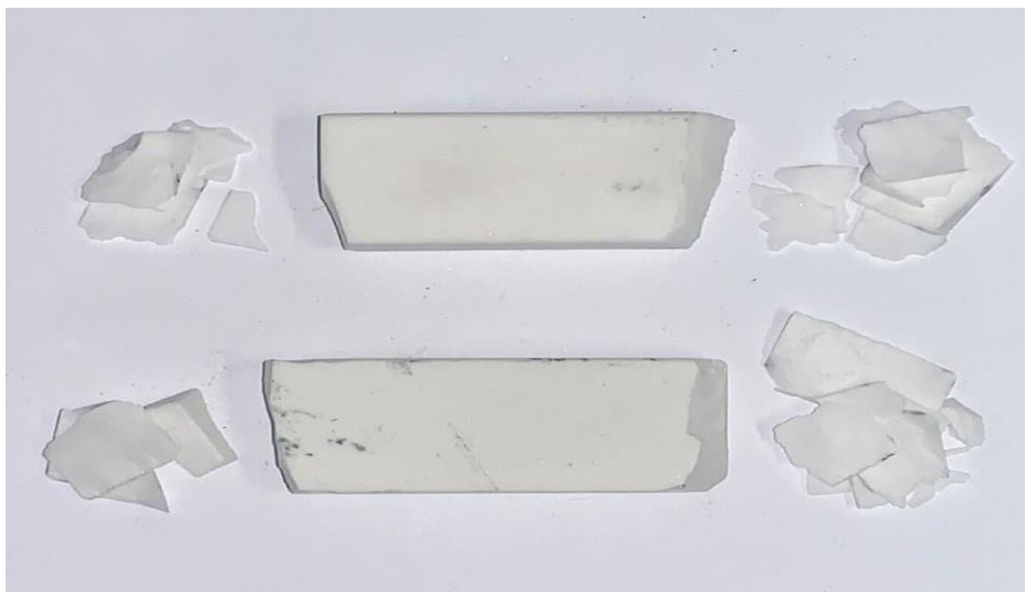
Figura 26: Amostras cerâmicas fragmentadas durante ensaio tambor-impulsor. Fonte: Pesquisa direta (2022)
