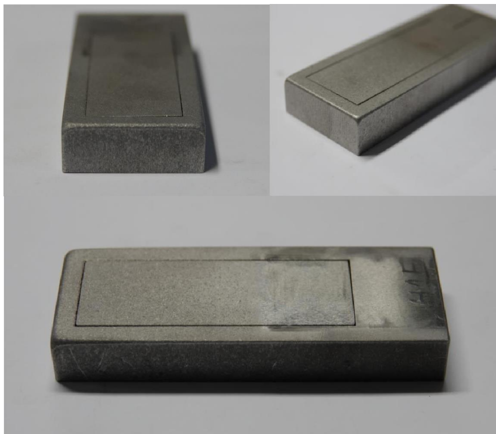
Figura 30: Corpos de prova H13 e HCCI após ensaio. Regiões de borda arredondadas e riscadas, regiões internas rugosas sem riscos.
