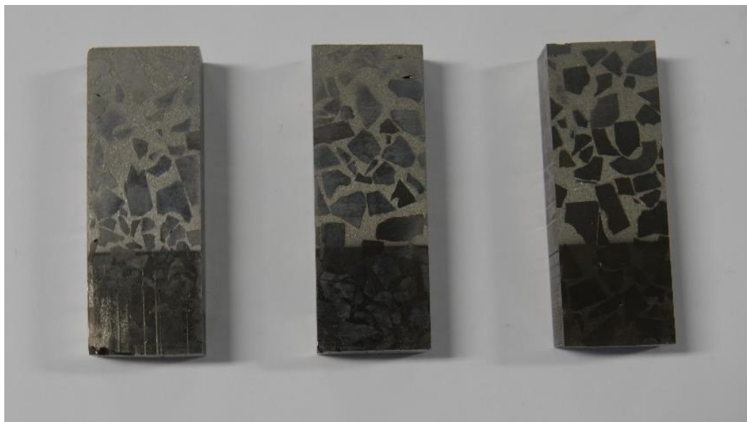
Figura 28: Amostras do material bimetalítico WC-Co após ensaio Tambor-Impulsor. Nota-se a presença dos carbonetos de tungstênio dispersos na matriz de ferro fundido nodular. Fonte: Pesquisa direta (2022)
