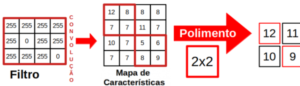
Figura 7 – Operação de pooling realizada no mapa de características resultante de uma convolução, utilizando a função max pooling . Fonte: Adaptado de Neves (2021)
