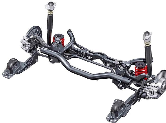
Figura 12 - Suspensão traseira multilink
