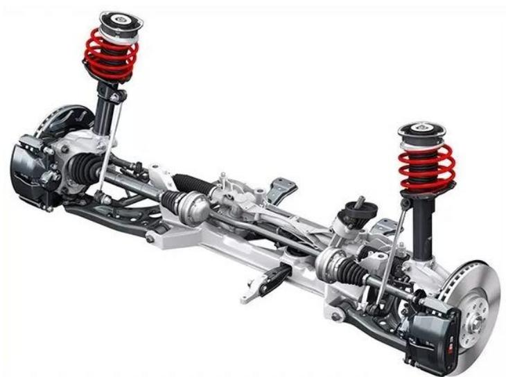
Figura 10 - Suspensão McPherson
