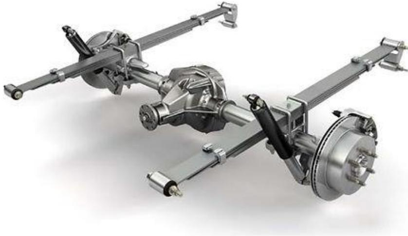
Figura 13 - Suspensão de Eixo Rígido com feixe de molas
