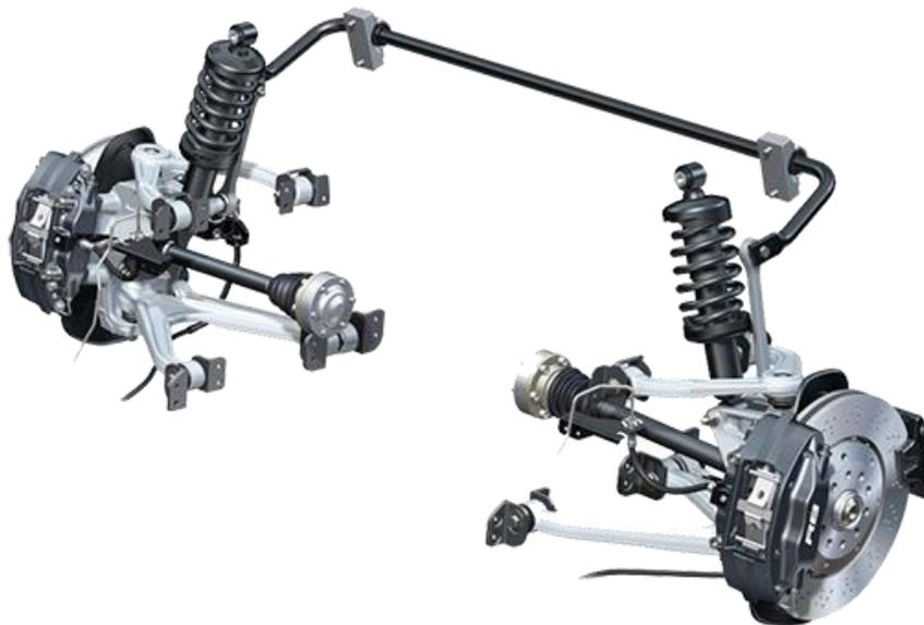
Figura 11 - Suspensão Double Wishbone
