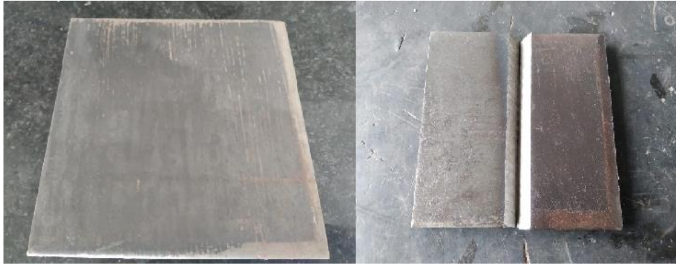
Figura 15 – Blank (à esquerda) e um par de amostra cortado e chanfrado (à direita)
