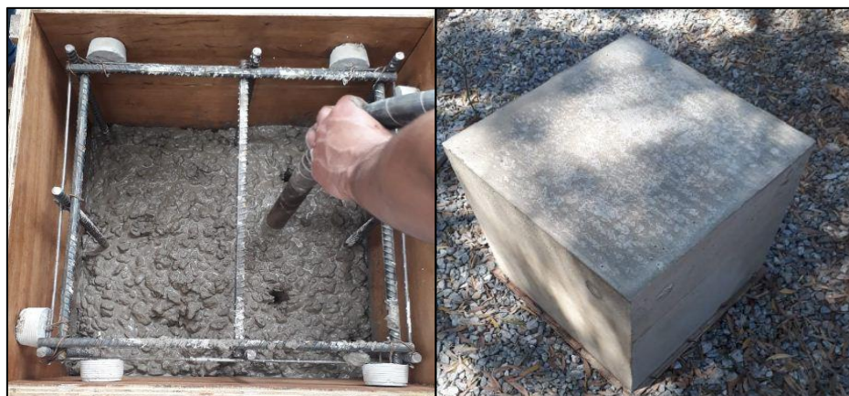
Figura 3.5 - Adensamento e aparência final do bloco.
