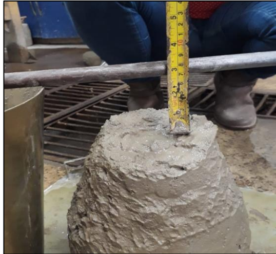
Figura 3.4 - Procedimento de slump Test
