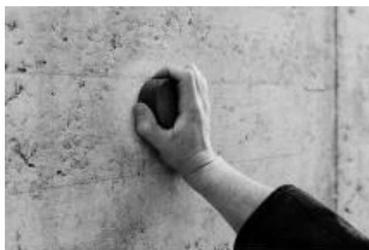
Figura 2.4 - Homogeneização da superfície de ensaio.
