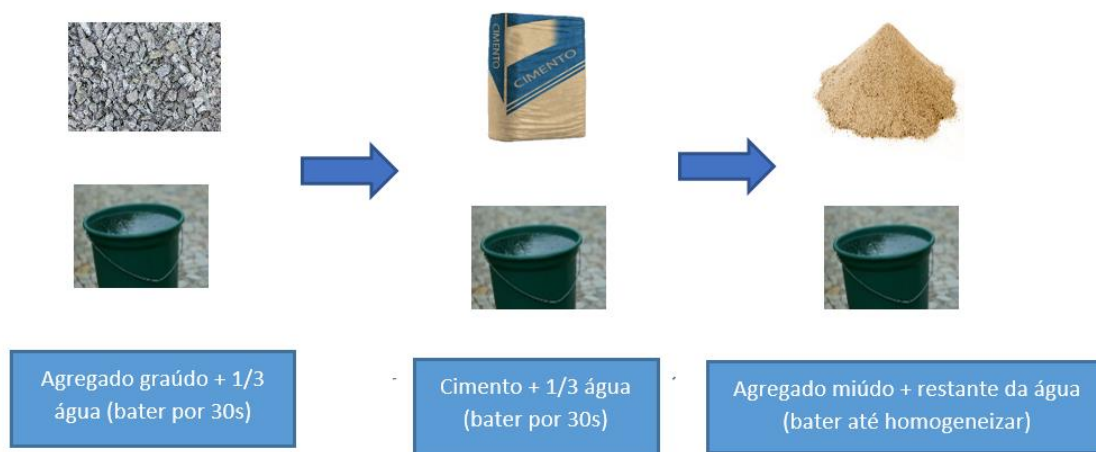
Figura 3.3 – Produção do concreto
