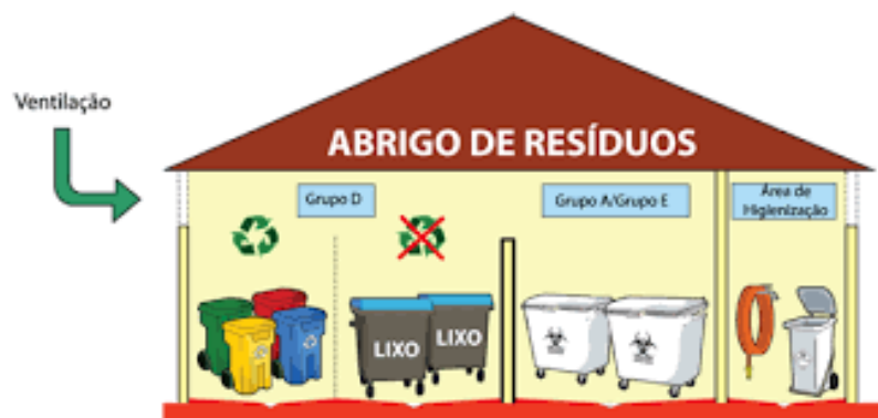
Figura 11 – Identificação de Abrigo Temporário de Resíduos.
