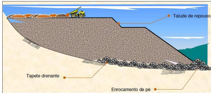
**Figura 5: Construção de pilha pelo método ascendente por camadas (FERREIRA, 2016).**
