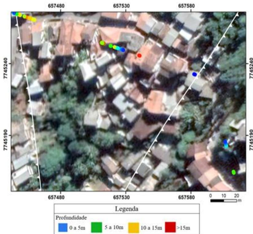
Figura 7.10: Pontos de anomalia magnética e sua profundidade na área sul.
