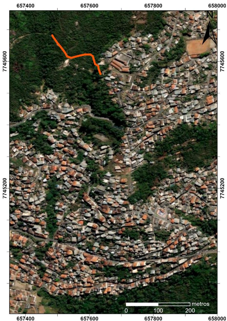
Figura 6.3: Linha pela qual foi realizado o levantamento de eletrorresistividade.
