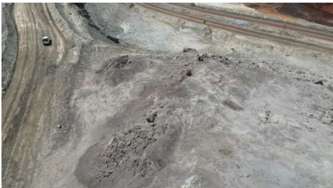
Figura 13 - Foto retirada por drone da massa desmontada
