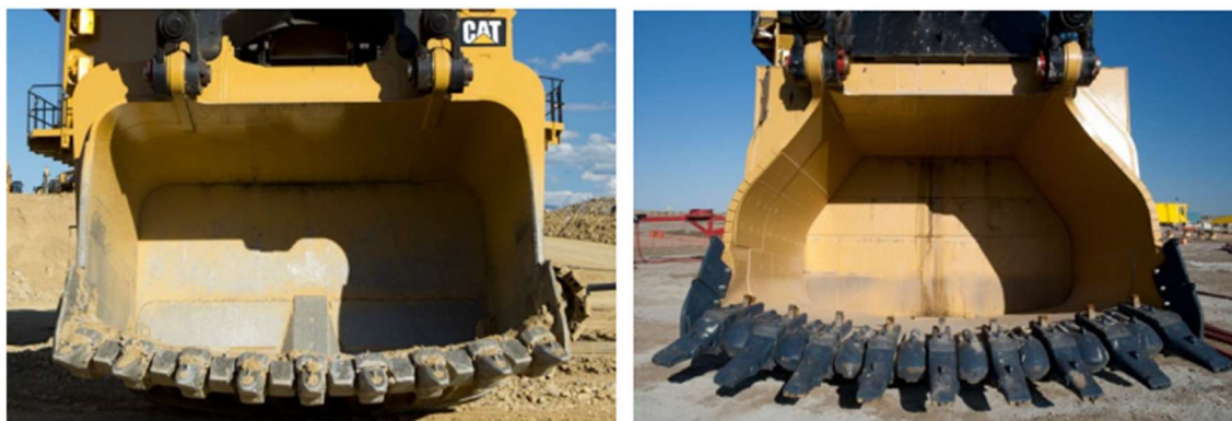
Figura 13 - Caçamba desgastada e substituição dos FPS
