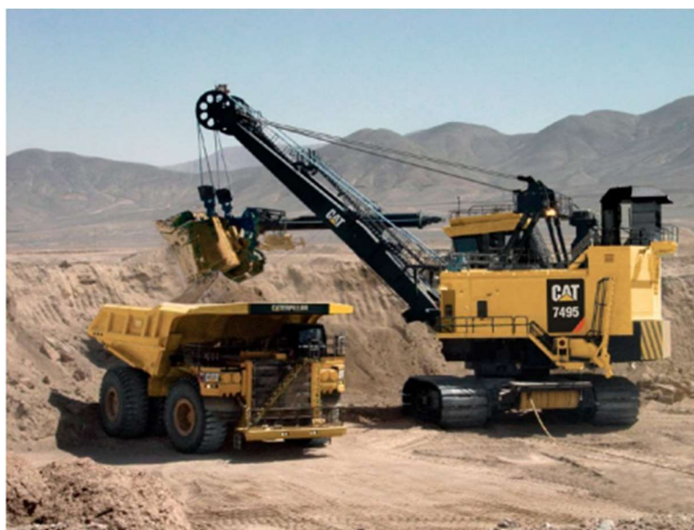
Figura 5 - Escavadeira a cabo CAT 7495
