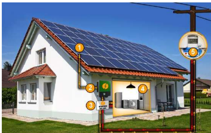
Figura 37: Passo a passo do funcionamento do sistema fotovoltaico conectado à rede.
