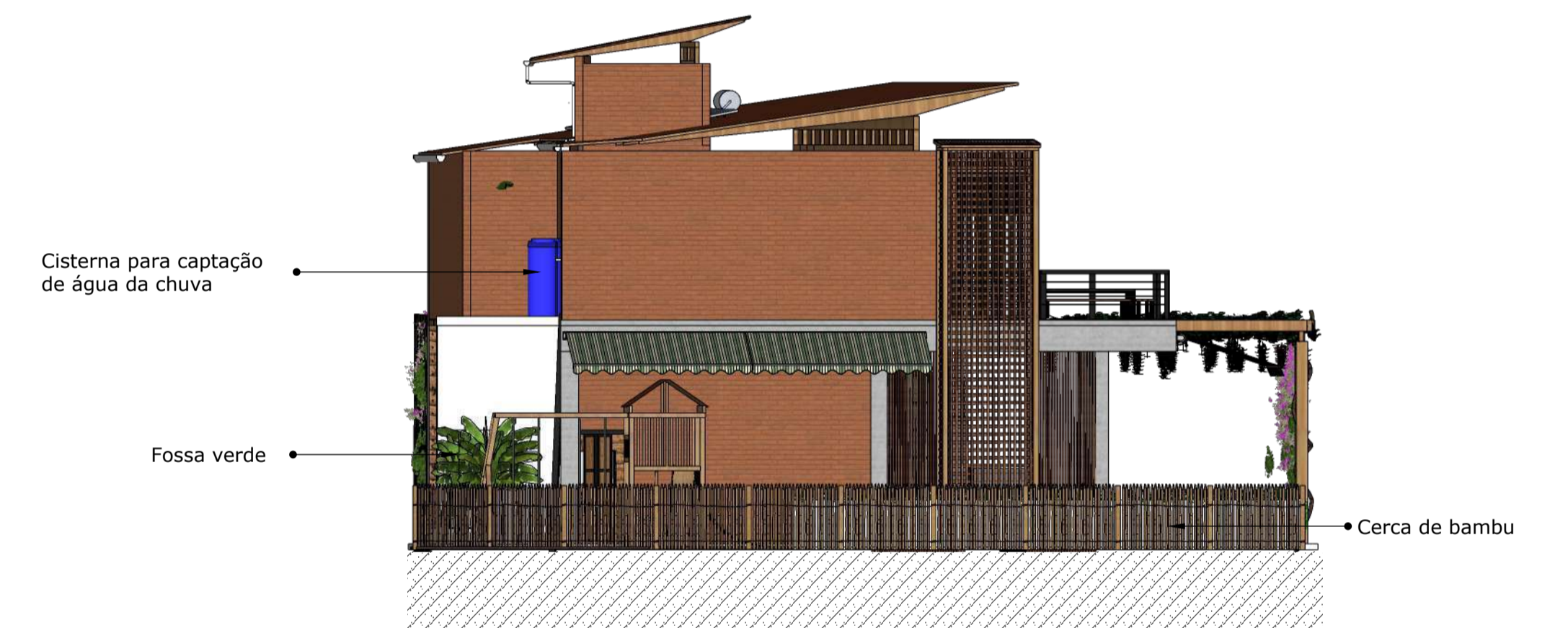
Fachada Posterior sem o muro ESC.: 1/100
