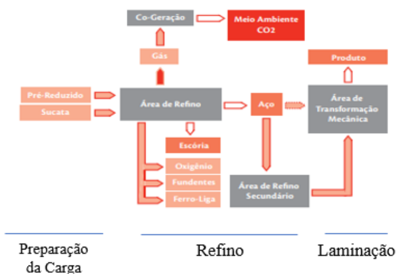
Figura 3. Processo Produtivo de uma Usina Semi Integrada.
