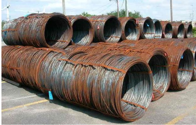
Figura 19 Danos por Ação Natural - Oxidação
