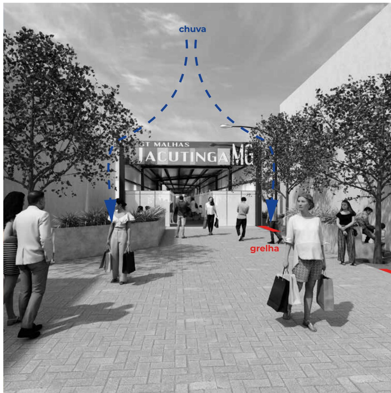
Considerando que a via será compartilhada, ou seja, terá um nível único para os carros e para os pedestres, o escoamento das águas será feito no limite de divisão dos pisos, através de bocas coletoras tipo grelhas.
