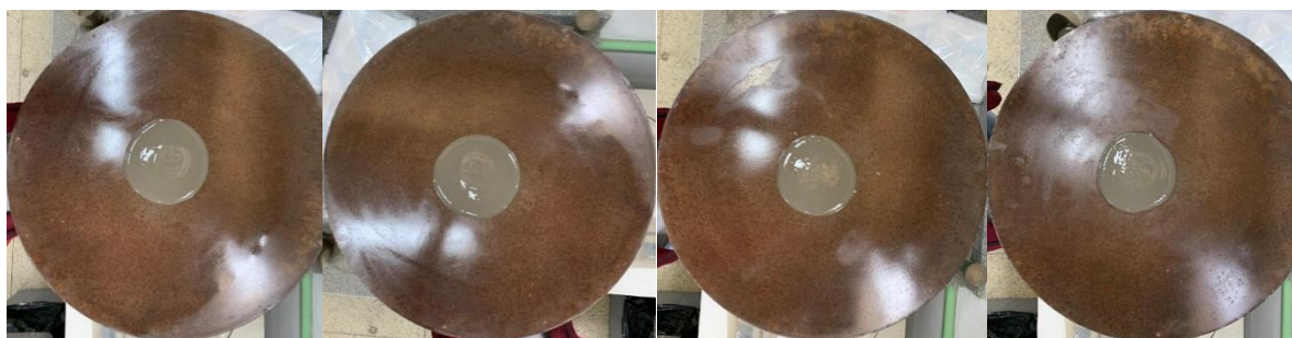
Figura 19: Evolução do espalhamento da pasta de cimento com ADr nas dosagens de 18%, 20%, 21% e 22%, respectivamente.
