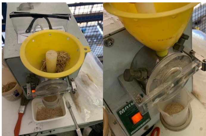
Figura 5: Moagem do bagaço de cana no moinho de facas.
