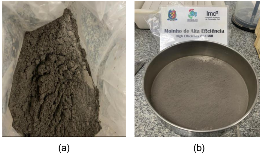
Figura 9: Escória resultante do (a) moinho de bolas e (b) moinho de alta eficiência.
