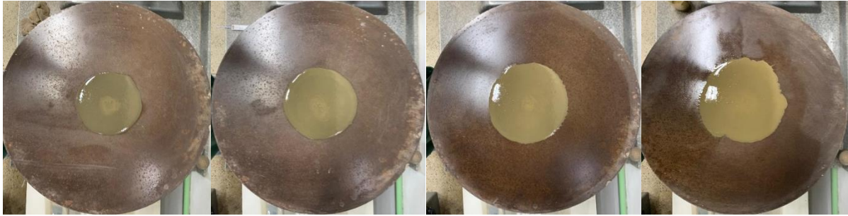
Figura 16: Evolução do espalhamento da pasta de cimento com ADc nas dosagens de 12%, 14%, 15% e 16%, respectivamente.
