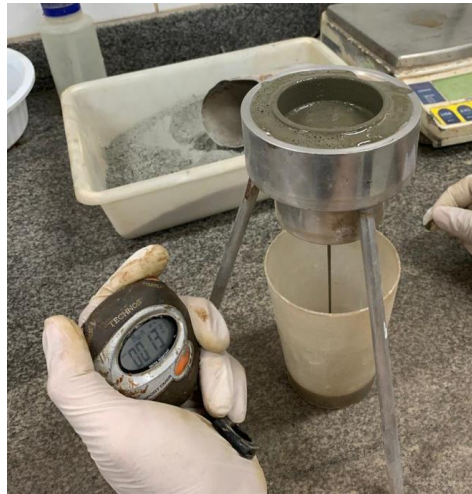
Figura 13: Ensaio de ponto de saturação no viscosímetro tipo copo Ford.
