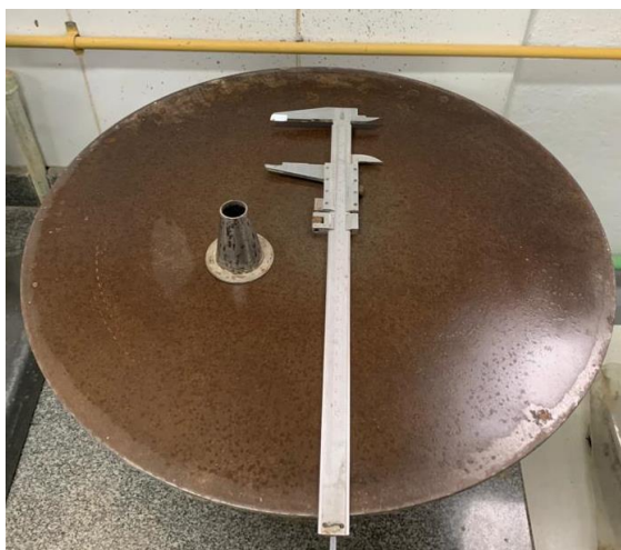
Figura 14: Mesa de abatimento, minicone e paquímetro.
