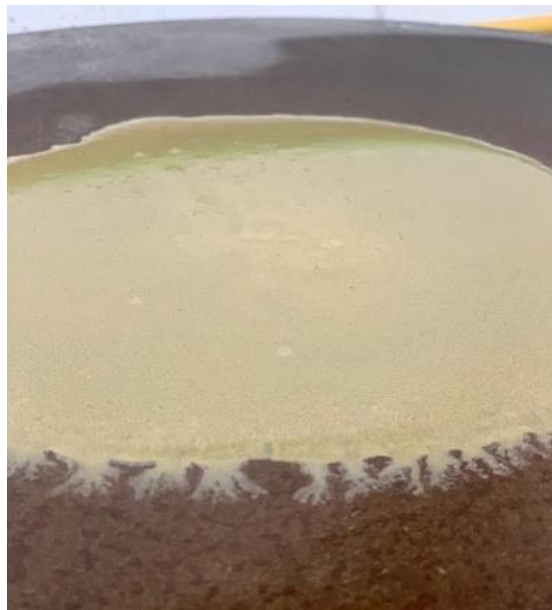
Figura 17: Princípio de exsudação na pasta aditivada com 16% de ADc.
