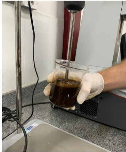
Figura 12: Homogeneização dos aditivos duais no agitador mecânico.
