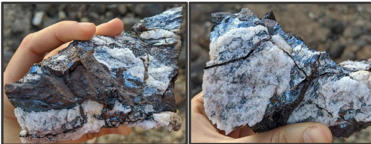
**Figura 4.20** - Fragmentos de hematita compacta da cava leste de Fábrica Nova.
