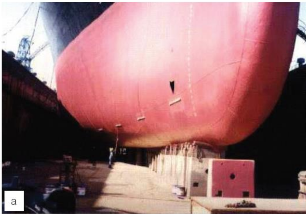
Figura 8 - Proteção catódica por anodo de zinco em casco de navio: (a) vista inferior do navio em dique seco; (b) fixação do anodo de zinco no casco do navio
