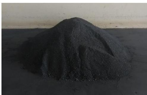
Para a separação das alíquotas necessárias para o teste de análise granulométrica, montou-se uma pilha alongada com comprimento de dois metros com 20kg de material, conforme apresentado na Figura 4.4.
