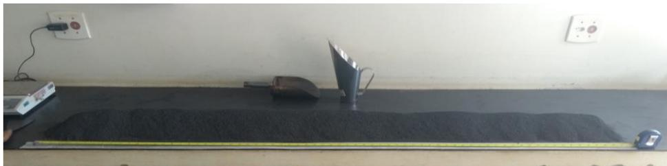
A Figura 4.5 mostra a esquematização da etapa de preparação das amostras para análise granulométrica.
