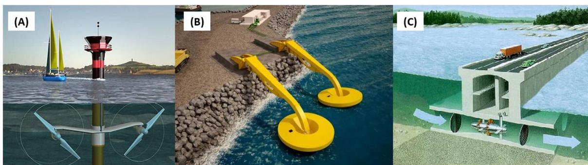
Figura 3.12 - (A) Gerador de energia por correntes marítimas, (B) Usina de ondas de Pecém – CE, (C) Sistema maremotriz.
