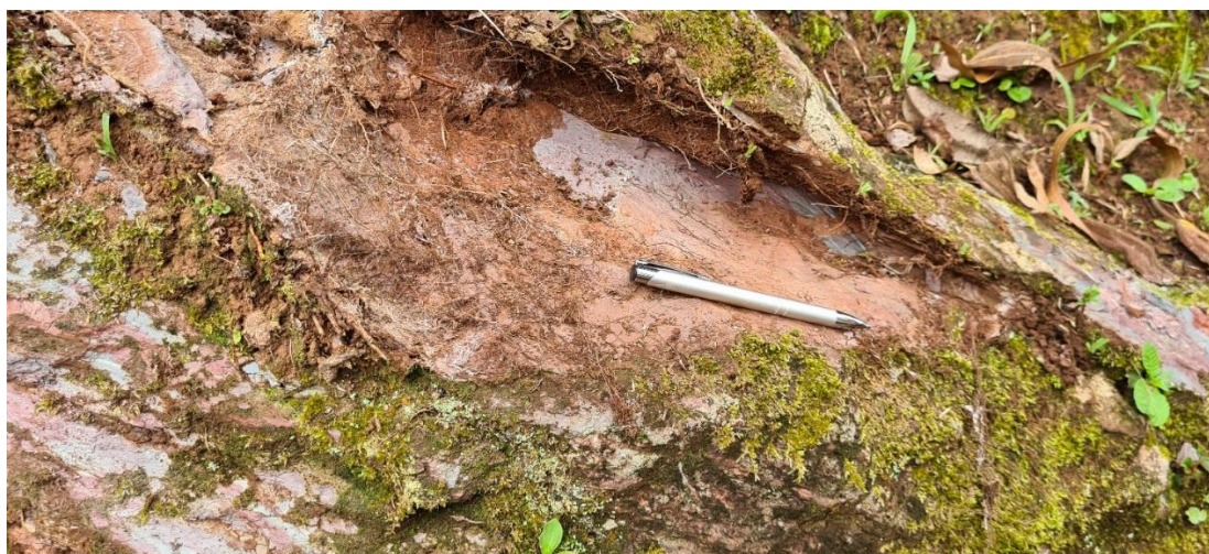
Figura 4-21 - Ponto M139 Filito cinza prateado, alterado e com intercalações milimétricas de níveis argilosos de baixa resistência (R1).
