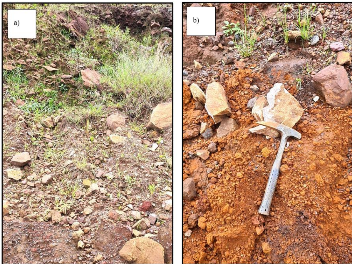
Figura 4-4 - (a) Ponto M119 - PDE na região sul - Grande diversidade composicional nas características de seus materiais de estéreis. (b) Ponto M118 - PDE SUL - Localmente podem ser observados níveis/camadas métricas de materiais de composição variada desde itabiritos argilosos a rochas quartzíticas em contato com grandes blocos podendo condicionar planos de anisotropias de resistência (análogos a descontinuidades) na estrutura.
