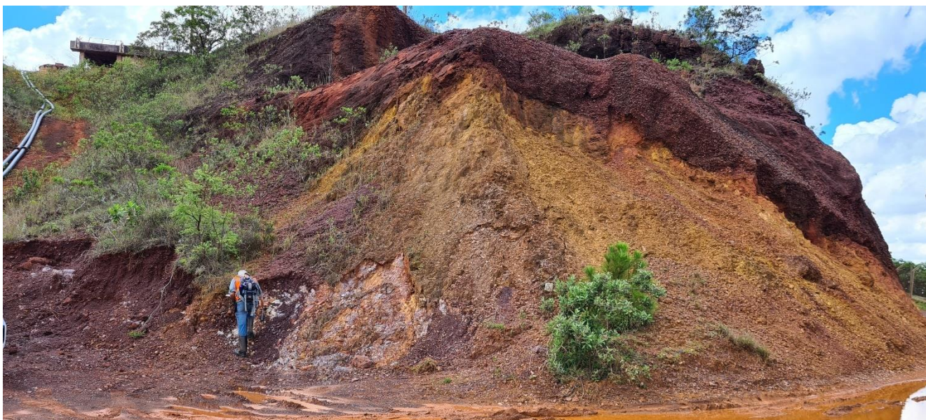
Figura 4-8 - Ponto M067 - Afloramento em canga recobrimdo filito dolomítico de baixa resistência no talude Leste, com espessura de até 5 metros.
