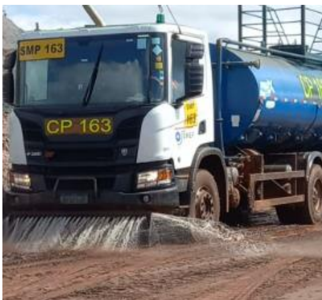
Figura 17. Caminhão pipa com barra adaptada irrigando a pista com o ea1
