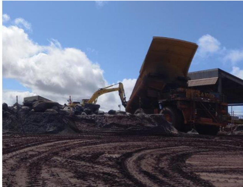
Figura 8. Caminhão basculando minério no britador
