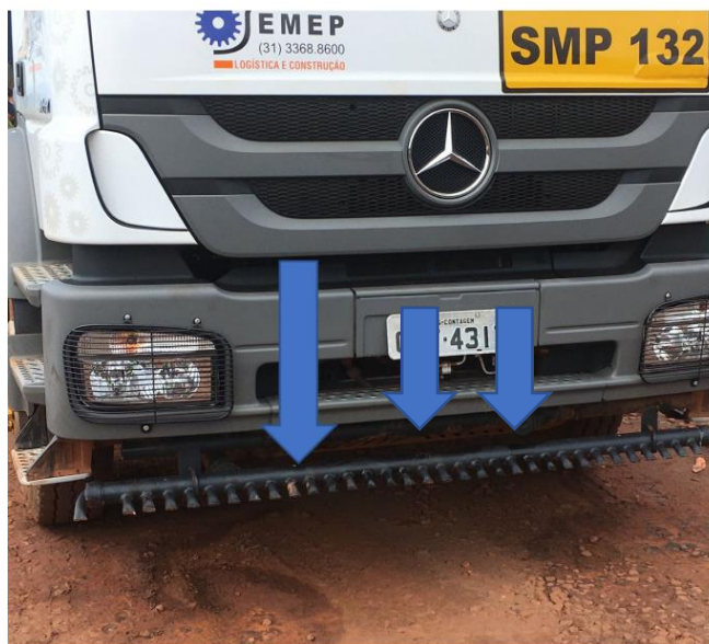
Figura 16. Caminhão pipa com a barra adaptada para aplicação do polímero
