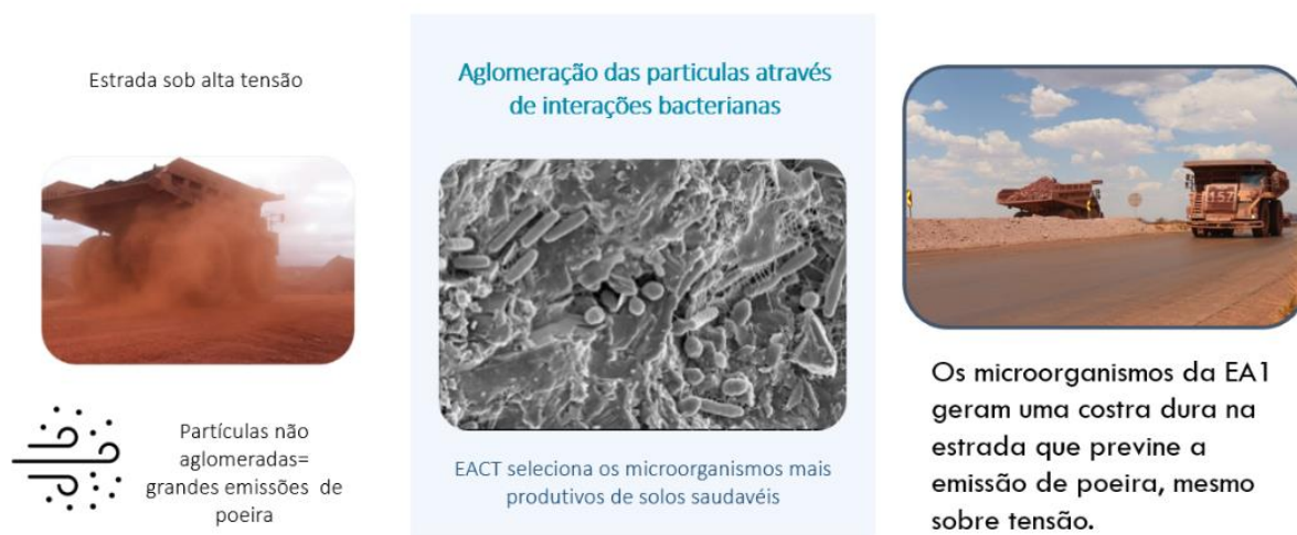
Figura 11. Funcionamento básico do ea1
