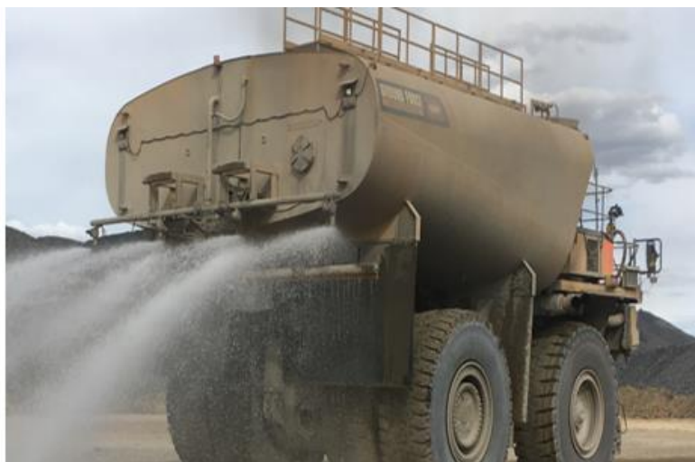
Figura 10 - Caminhão pipa umedecendo vias de acesso
