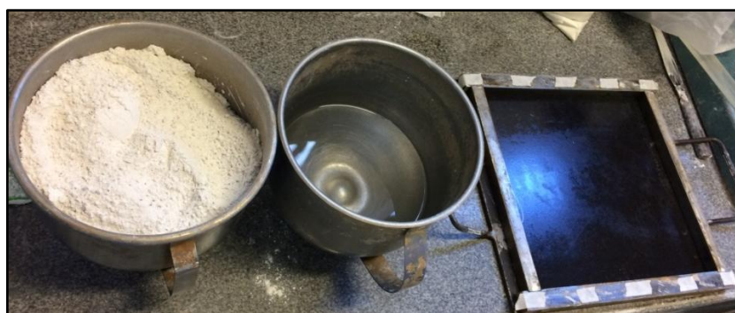
Figura 6 – Mistura do Compósito, Água e Fôrma da Placa, respectivamente
