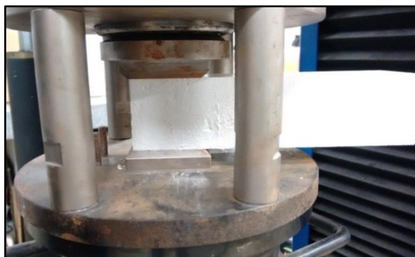
Figura 11 – Corpo de prova sujeito à compressão - Compósito
