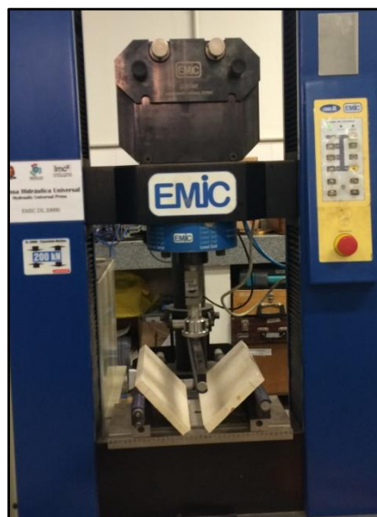
Figura 17 - Placa de Gesso ensaiada
