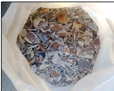
Figura 4 – Rejeito de fibra de vidro triturado
