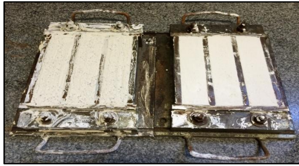
Figura 8 – Copos de Prova para ensaio de Compressão: Compósito e Gesso, respectivamente.
