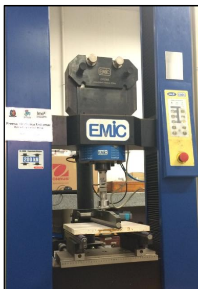
Figura 12 – Corpo de Prova sujeito ao ensaio de ruptura na flexão - Gesso
