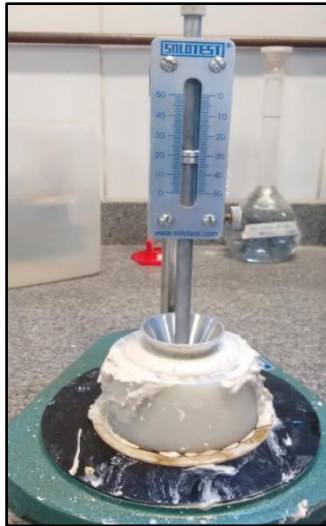
Figura 14 – Consistência Normal: Compósito
