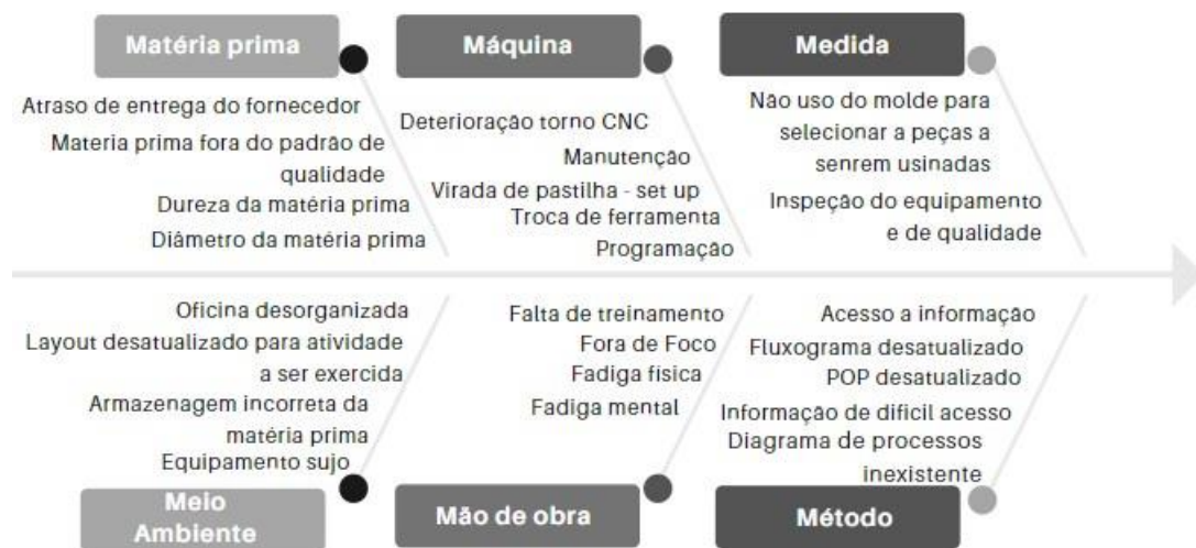
Figura 3 -Diagrama de Ishikawa – Representação das Causas de Baixa produtividade no Processo de fabricação de roscas trapezoidais
