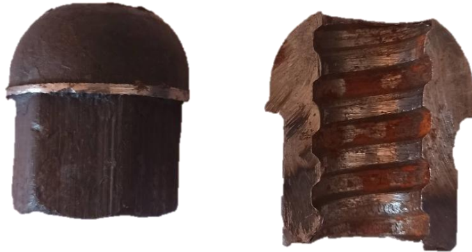
Figura 1: Porca com corte lateral com rosca trapezoidal
