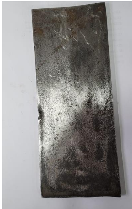
Figura 4.1. Chapa de aço de baixo carbono parcialmente lixada com espessura de 4,6mm, 200mm de comprimento e 100mm de largura utilizada para deposição de cordões de solda, pelo processo SMAW.
