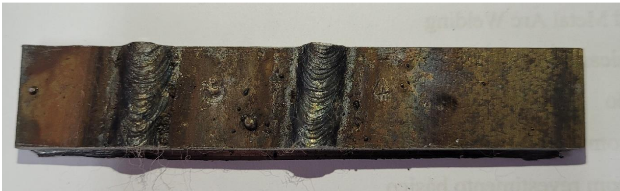
Figura 5.2. Cordões de solda com o eletrodo E7018 nas polaridades CC^+ e CC^- .
