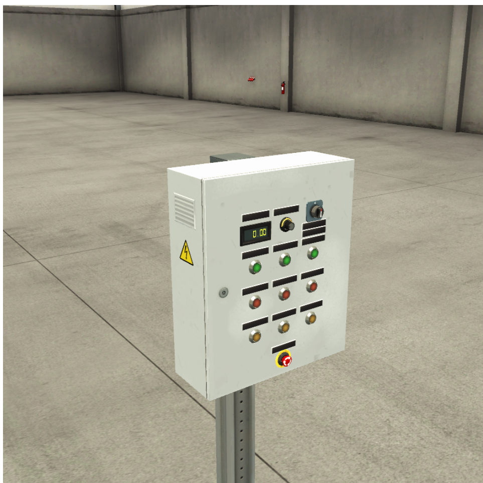
Figura 1 – Exemplo de painel de comando feito utilizando o software Factory I/O . As botoeiras são também chamadas de atuadores, e quando acionadas permitem a passagem ou não de corrente elétrica, dependendo da sua natureza NA , geralmente expressa na cor verde, ou NF , geralmente expressa na cor vermelha.
