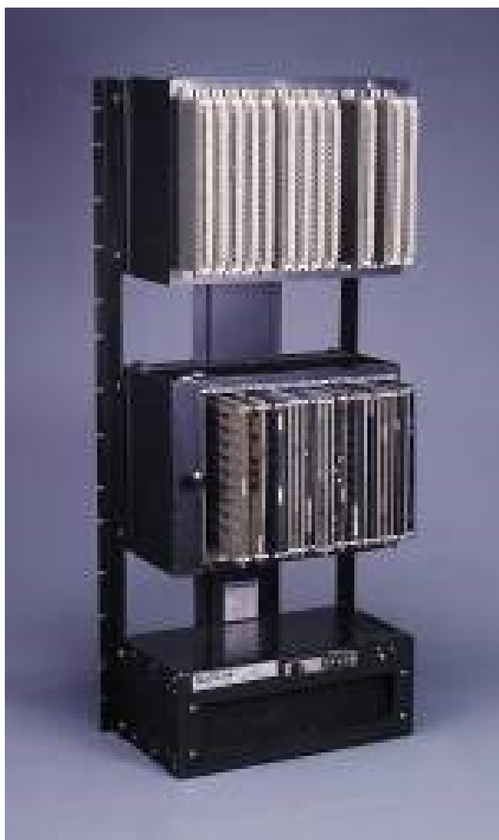
Figura 2 – O CLP Modicon 084, controlador industrial programável que representou um marco na indústria, tornando-se um dos precursores dos modernos CLP. Fonte: Ferraz (2018).
