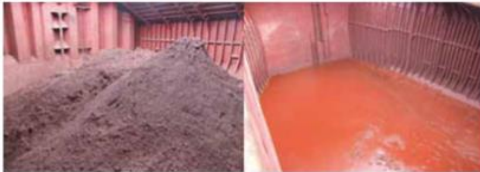
Figura 2 – Minério de ferro antes (esquerda) e após a liquefação (direita).
