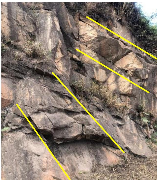
Figura 16 - Famílias de descontinuidades do talude rochoso.
