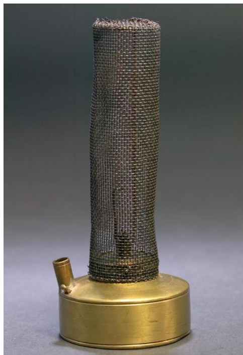
Figura 13 – Primeiro modelo da Lâmpada de segurança de Davy presente no laboratório da Royal Institution. Fonte: Davy (1815) .
