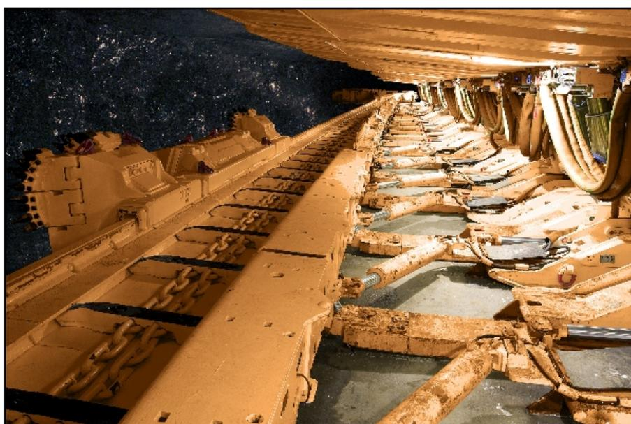
Figura 16 - Sistema de equipamento utilizados na lavra por *longwall*
