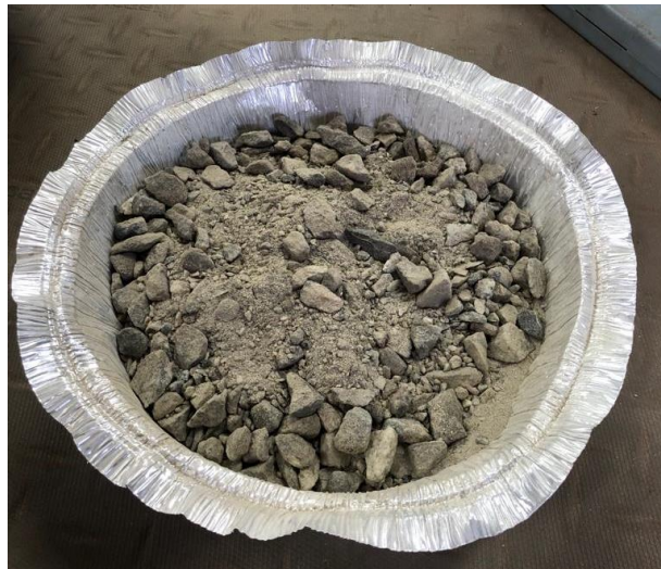
Figura 10 – Material resultante do processo de extração de betume da massa asfáltica com aparelhagem adequada. Fonte: Arquivo pessoal.
