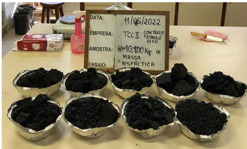
Figura 6 – Separação e pesagem da amostra de massa asfáltica no Laboratório de Pavimentação Asfáltica. Fonte: Arquivo pessoal.
