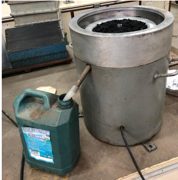
Figura 9 – Esquema de instalação dos equipamentos para realizar ensaio, utilizando o aparelho Rotarex. Fonte: Arquivo pessoal.
