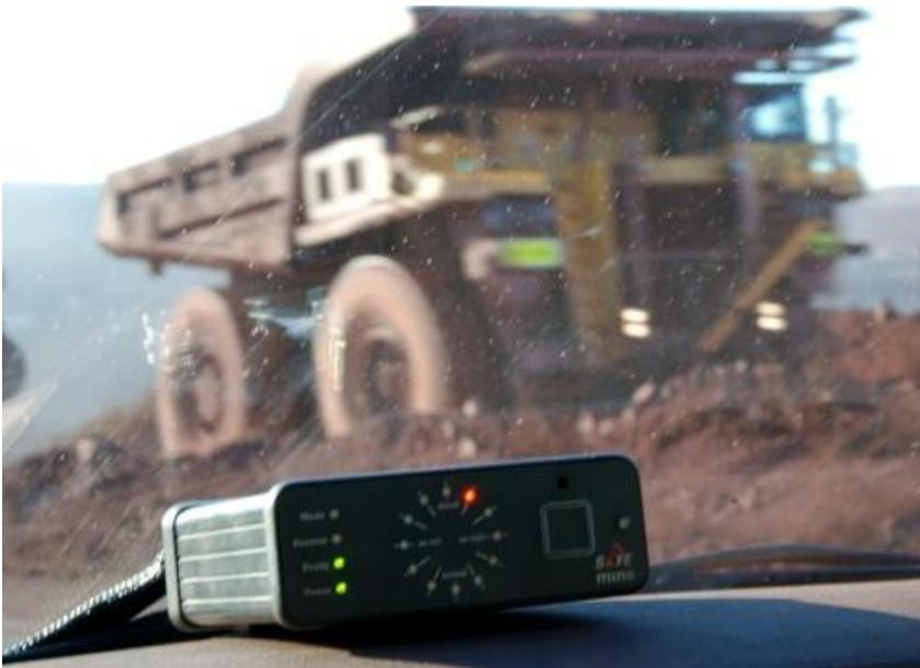
FIGURA 04 – Módulo de um *Close Proximity System* no painel de um caminhão fora de estrada (SAFEMINE, 2016).
