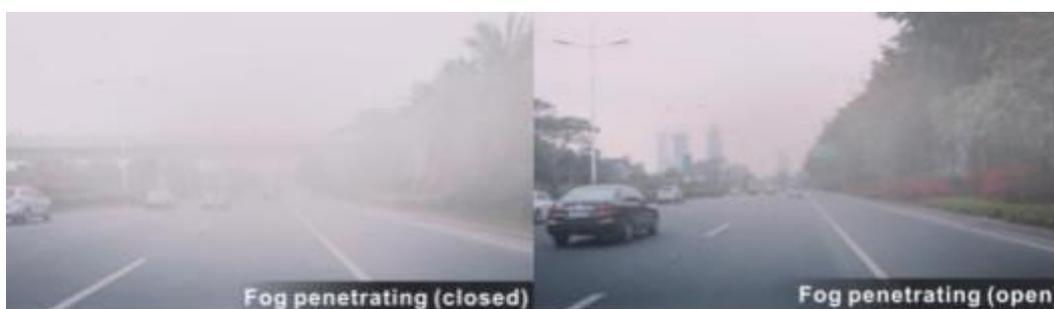
FIGURA 11 – Comparativo de visibilidade numa situação sob neblina com a câmera desligada (esquerda), e ligada (direita). NV-SC150 (PROTRULY, 2016).
