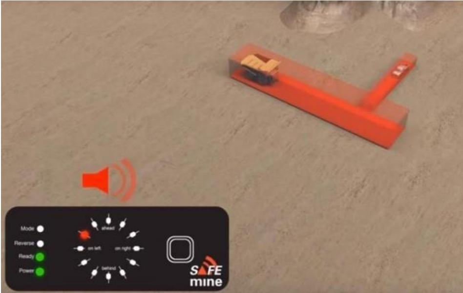
FIGURA 09 – Sistema CPS em ação, alertando os condutores da aproximação dos veículos mediante uma intersecção (SAFEMINE, 2016).
