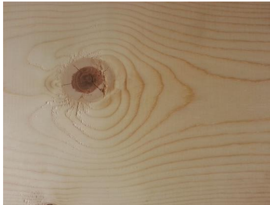
Figura 9 - Representação da presença de um nó vivo em um segmento de madeira. Fonte: Bayer, 2013.
