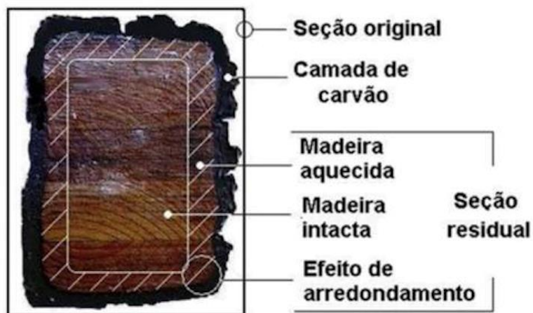
Figura 8 - Exemplo de uma seção de madeira após o processo de carbonização. Fonte: Blog Engenheiro Madeireiro, 2018.
