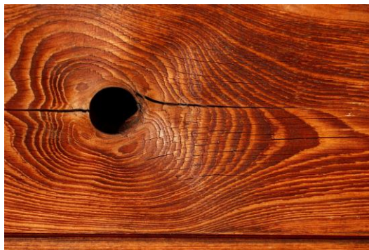
Figura 10 - Representação da presença de um nó morto em um segmento de madeira. Fonte: Szoke, 2015.
