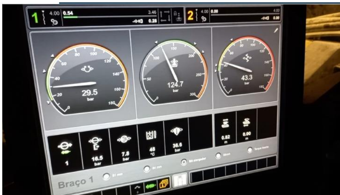
Figura 24: Parâmetros de utilização para a atividade de perfuração.
