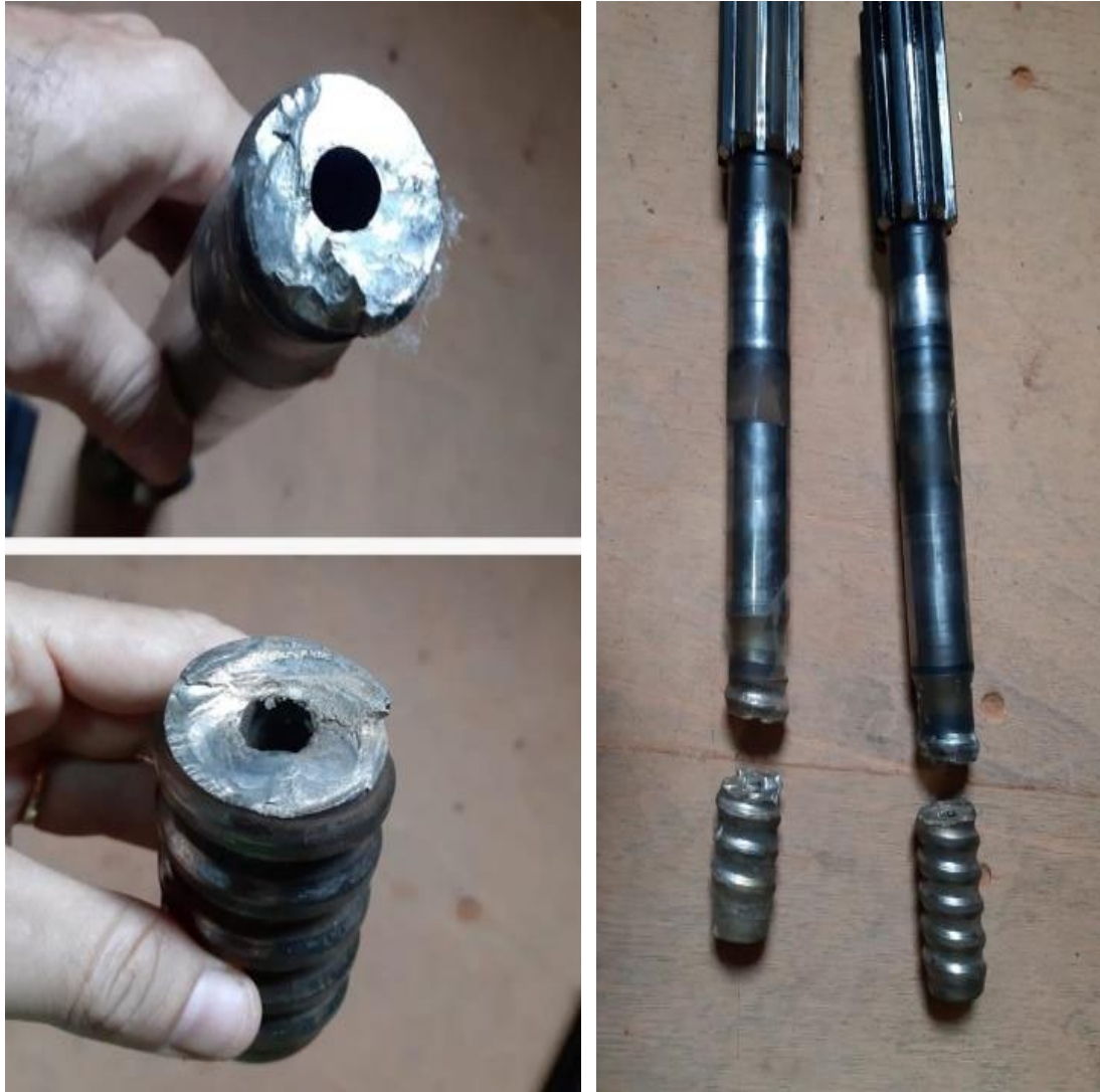
Figura 26: Padrão e local da falha.
