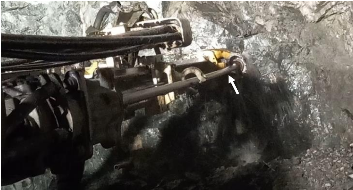
Figura 25: Flambagem da haste de perfuração (seta).
