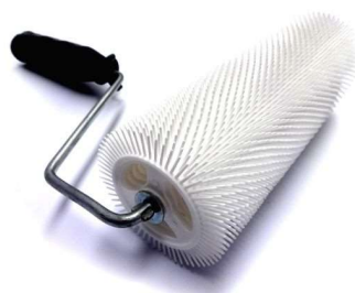
Figura 6 – Rolo fura bolha empregado para retirar as bolhas incorporadas na resina, além de contribuir para o nivelamento do material.
