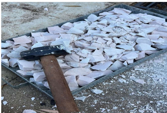
Figura 17 – Trituração do resíduo de vidro fornecido pela Divinal Vidros.
