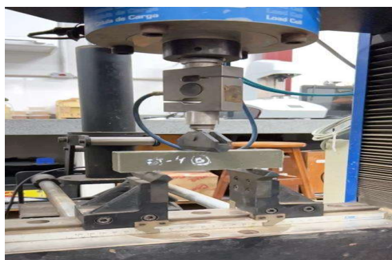
Figura 22 – Ensaio de tração na flexão com 3 pontos realizado na prensa servo-controlada universal no LMC/UFOP.
