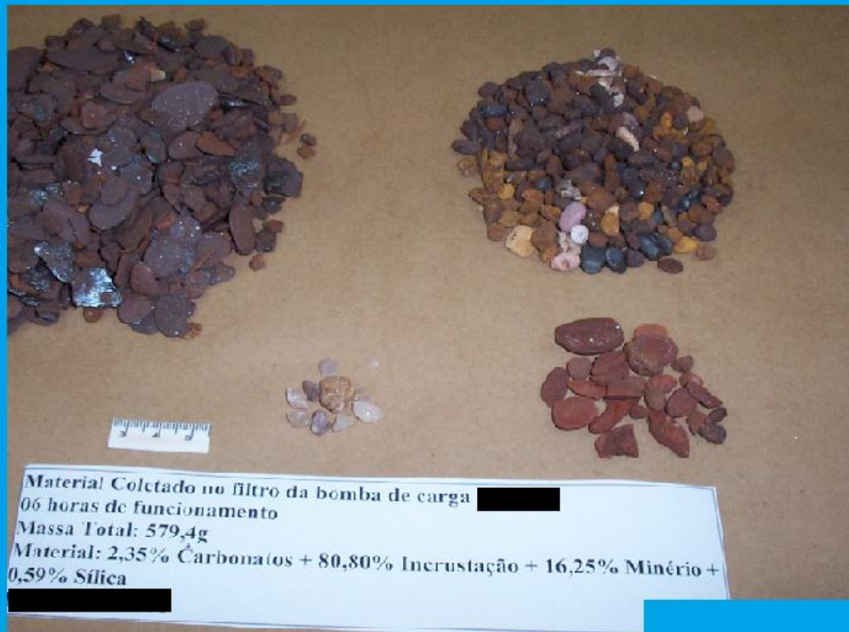
Figura 16 – Aspecto e caracterização de particulado grosseiro retido no filtro Fonte: Pesquisa direta (2017)
